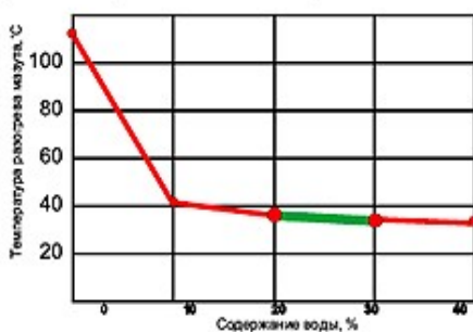
Температура разогрева мазута в зависимости от количества воды
