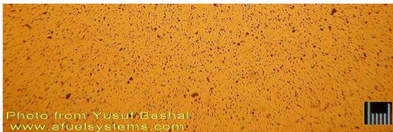
Исходный котельный мазут (Турция) , увеличение 200 раз, линейка 10 микрон (вверху) Гомогенизированный котельный мазут (Турция), увеличение 200 раз, линейка 10 микрон (внизу)
